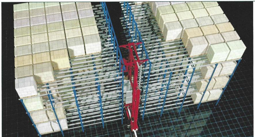
Abb. 1: Kompaktlager mit einem Regalförderzeug.
