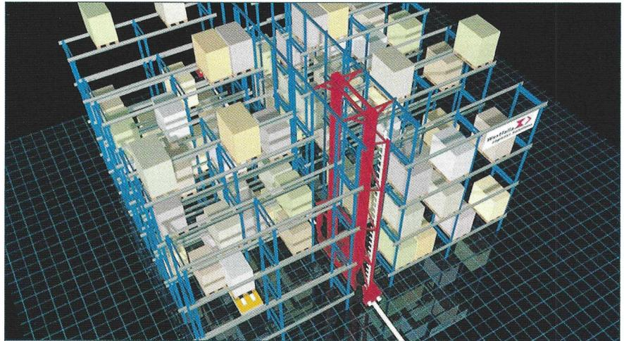
Abb. 3: Paletten-Einzelplatzlager: Zugriff des Satelliten auf Einzelplätze.
