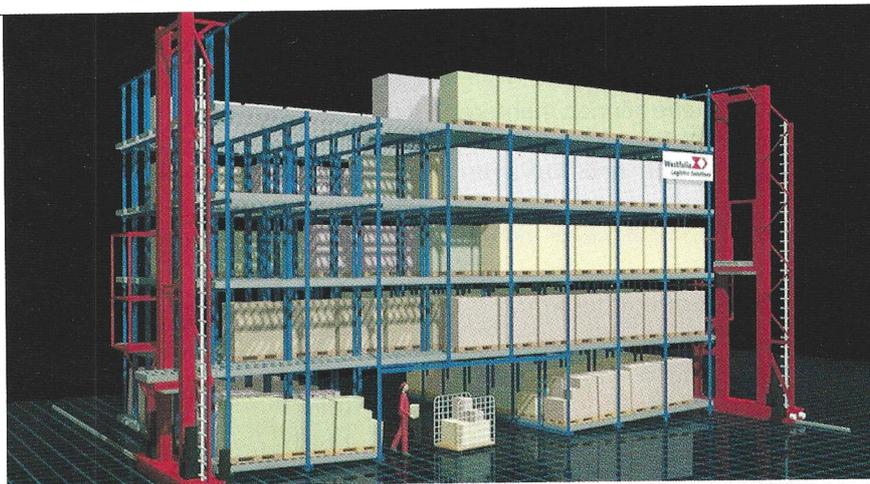
Abb. 2: Kompaktlager mit integrierter Kommissionierzone.
